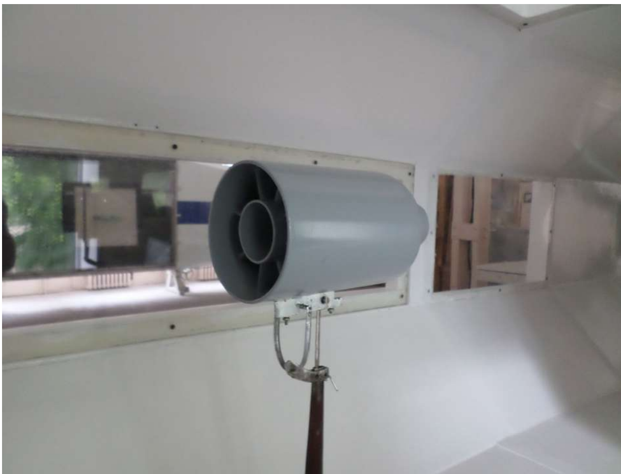
Рис.3.5. Установка моделі мотогондолі в робочій частині аеродинамічної труби АТ-1
