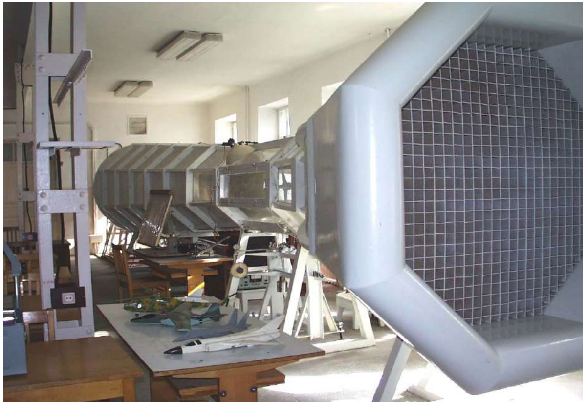
Рис.3.7 Дозвукова аеродинамічна труба АТ-1
