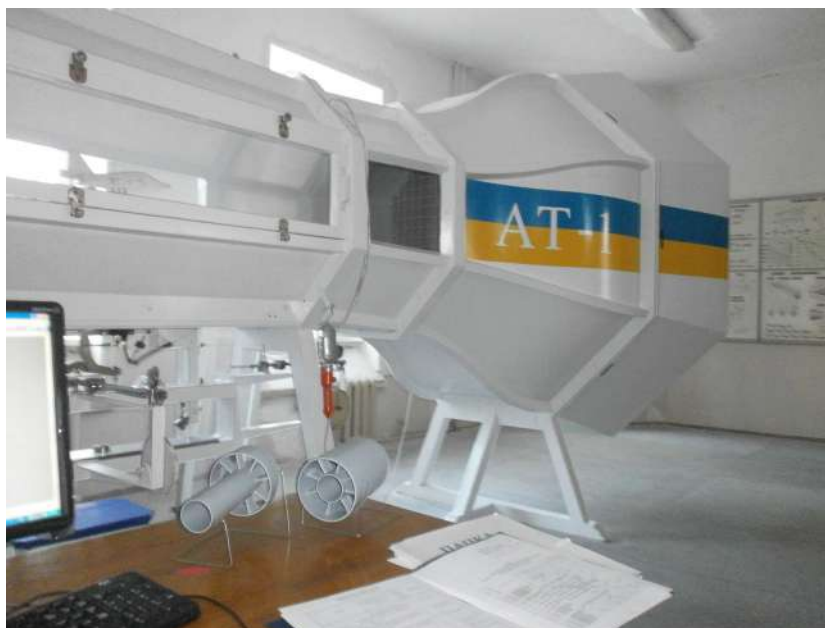
Рис.3.2. Експериментальна установка для аеродинамічних досліджень моделей мотогондол авіаційних силових установок АТ-1
