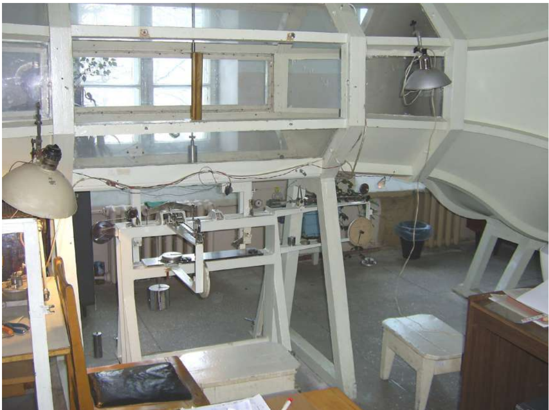
Рис.3.3. Двокомпонентні аеродинамічні ваги КВТ-1
