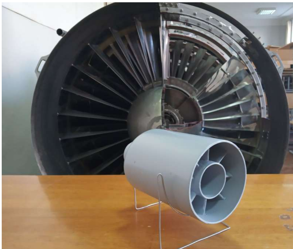
Рис.3.10. Модель мотогондoli ТРДД с традиційним переднім розташуванням вентилятора
