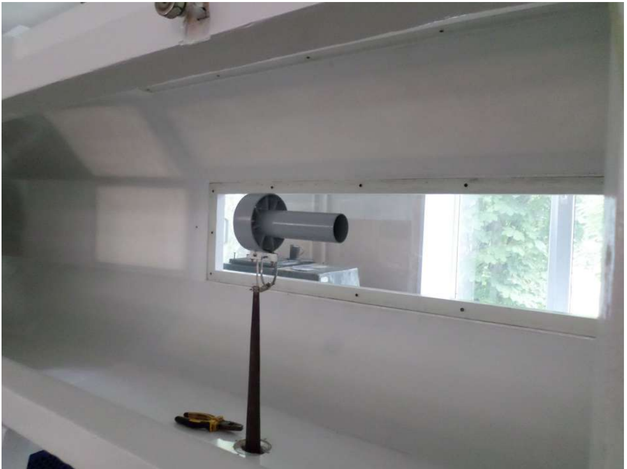
Рис.3.6. Установка моделі ступінчастої мотогондолі в робочій частині аеродинамічної труби АТ-1
