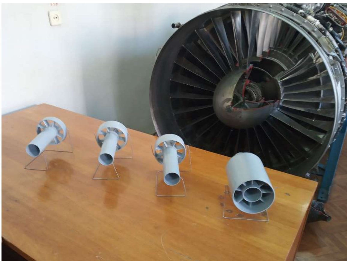
Рис.3.9.Моделі мотогондол для експериментальних досліджень
